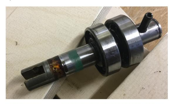
Da die Lager nicht mal eben auf die Welle rutschen, werde ich die Welle in den Tiefkühler legen und die Lager kurz vor dem aufschieben erwärmen.
