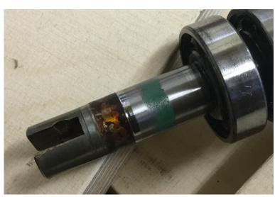
Die Welle ist durch den defekten Simmerring reif für den Wechsel. Auch dort wo der Stift des Impellers greift, ist ein deutlicher Verschleiß zu erkennen.
