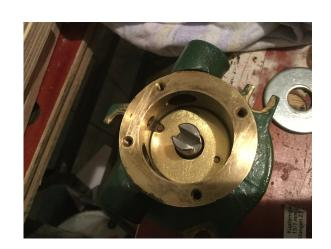
Pumpennocke einsetzen und mit der Schraube und Kupferdichtung fest schrauben.
