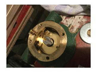
Laufflächen und Impeller gut mit beigefügtem Glyzerin benetzen.
