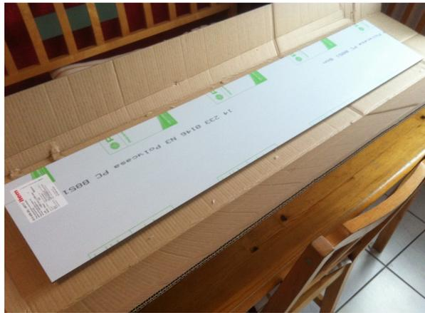
Zu erst müssen die Scheiben mal auf Maß gefräst werden. Hört sich kompliziert an, **isset aber garnicht**. Man nehme die alte Scheibe, lege die Neue darauf, und darauf ein Brett zum auffüttern des Fräskopfes. Und als kratzfeste Unterlage für das plane Führen der Fräse. (Die Form des Brettes spielt keine Rolle, nur die Stärke. Was übersteht fällt eh der Fräse zum Opfer.)
